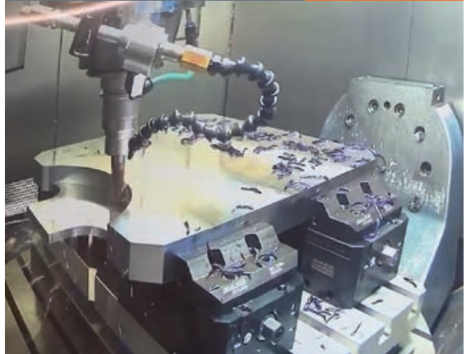
Mehrfachspannung von Großbauteilen Multiple clamping of large components
