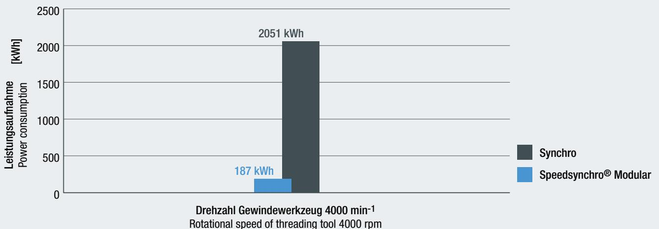
**3 Vorteil Axialkraftreduzierung am Gewindewerkzeug** Advantage Reduction of axial force on threading tool
