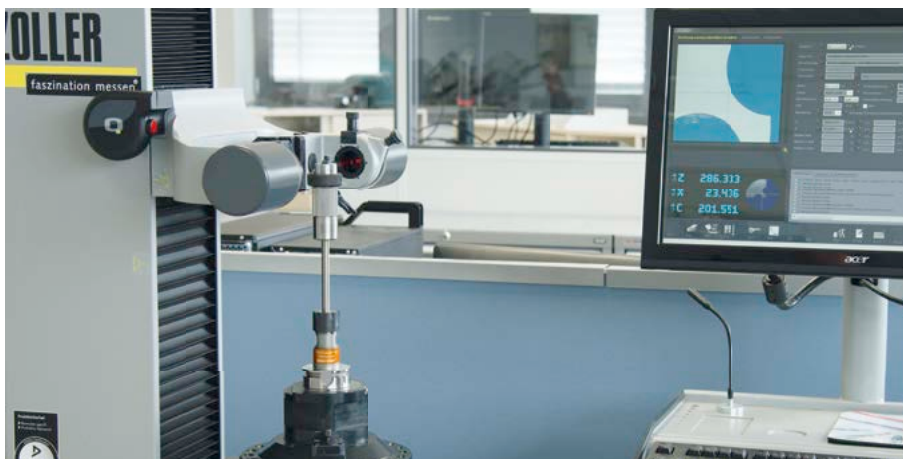
Voreinstellgerät zur vollautomatischen Messung, inklusive automatischer Rotation Presetting device with automatic measuring, including rotation.
